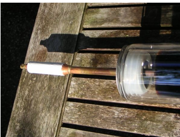
Afbeelding 7: Heat pipe met warmtegeleidende pasta
