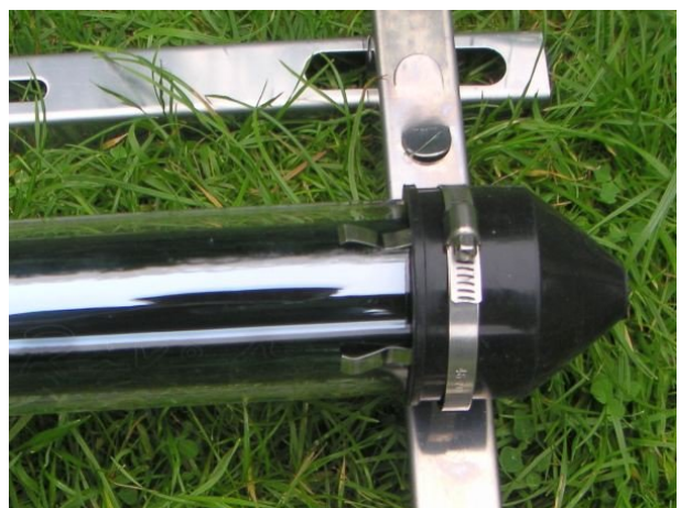
Afbeelding 8: Bevestiging van buis door middel van klemring
