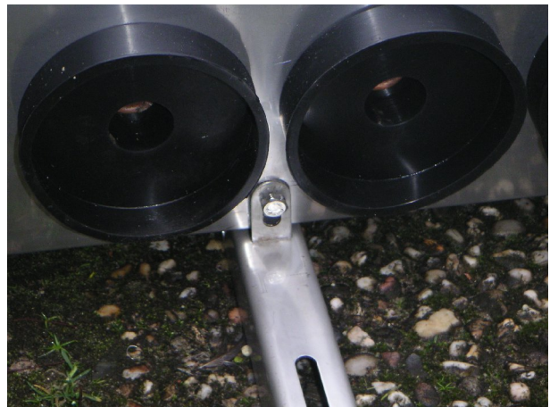
Afbeelding 2: Bevestiging op langsliggers
